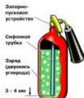
**ПРИНЦИП ДЕЙСТВИЯ** основан на вытеснении двуокиси углерода избыточным давлением. При открывании запорно-пускового устройства Со, по сифонной трубке поступает к раструбу и из сжатого состояния переходит в твердое (снеглообразное). Температура резко (до -70°C) понижается. Углекислота, попадая на горячее вещество, изолирует его от кислорода.
